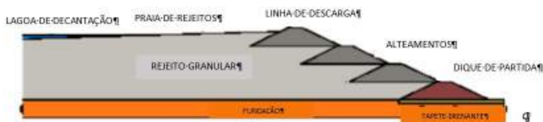
Figura 21 – Diagrama esquemático do método de alteamento à montante
